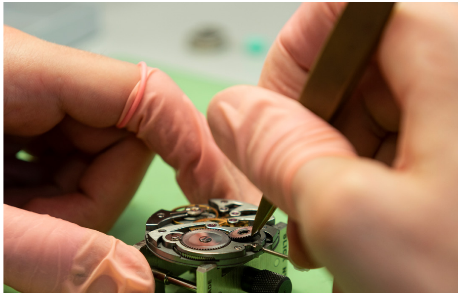
Die Unruh ist das Herz der mechanischen Armbanduhren. Bei vielen Modellen gibt Askania durch einen Sichtboden aus Saphirglas den Blick auf die goldene Unruh frei
